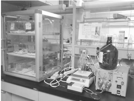
図4 アルコール暴露させるためのチャンバー。ケージごとマウスを入れて、アルコール気化蒸気を20日間吸引させる。
